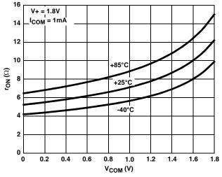
FIGURE 10. ON-RESISTANCE vs SWITCH VOLTAGE
