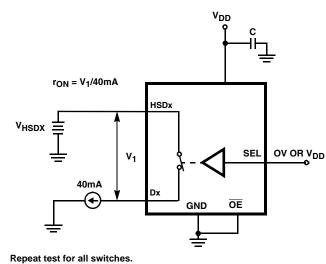
FIGURE 3. r<sub>ON</sub> TEST CIRCUIT
